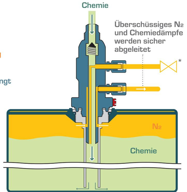
\* Um ein Eindringen von Chemie in die N<sub>2</sub>-Leitung zu verhindern sollte ein Absperrventil (z.B. Rückschlagventil, Membranventil oder Kugelhahn) in der Leitung vorgesehen werden.
