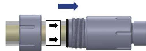
8. Kontermutter auf Knickschutz aufschrauben und festziehen.
