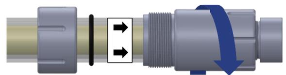
7. O-Ring bündig an Knickschutz anlegen.
