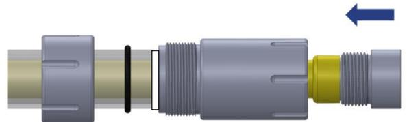
6. Knickschutz auf Flare-Verschraubung bis zum Anschlag aufschrauben und festziehen.
