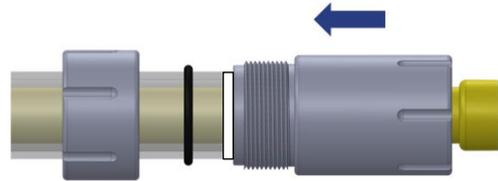
5. Flare-Verschraubung (z.B. Anschluss Entnahmekopf) in den aufgeweiteten PFA Schlauch einführen.
